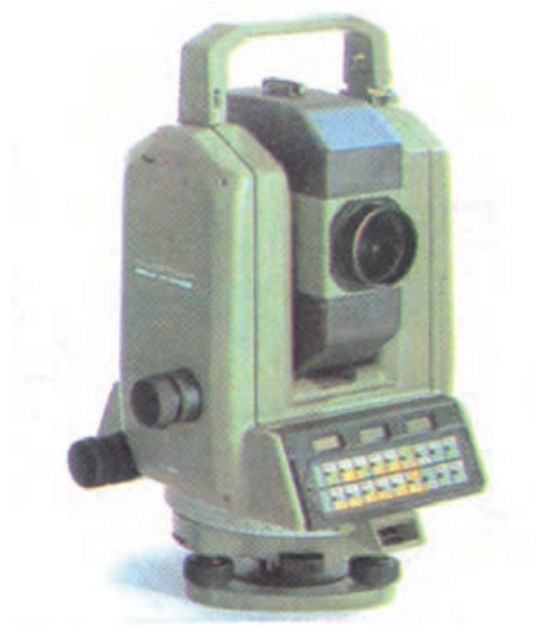
شکل ۲۴-۴ فاصله‌یاب در داخل دوربین نقشه‌برداری
